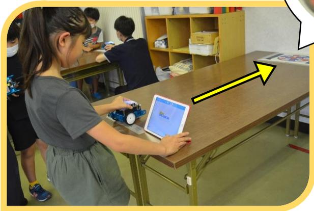
↑ロボットが的の上で止まる様にプログラミングを設定。
